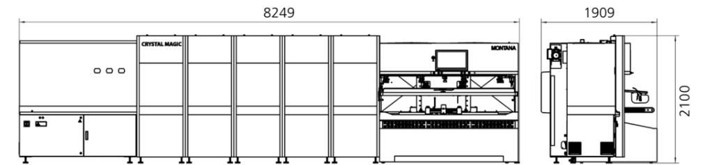
Hochleistungs Roboter mit zwei Steinen. Automatisches Steinschleifen für 1 Paar Ski oder 1 Snowboard mit PRO-Technologie.
