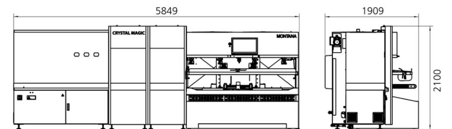
Allround-Roboter mit einem Stein. Automatisches Steinschleifen für 1 Paar Ski oder 1 Snowboard mit PRO Technologie.
