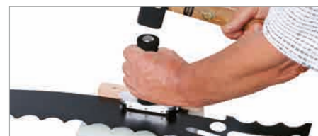
Ausstanzen des Reparaturbelages Punching out the patching material Découpez le matériel de réparation Punzonatura della superficie di riparazione
