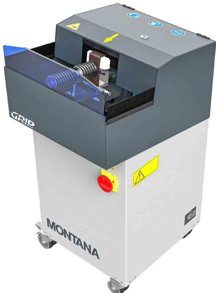
**L**a MCS GRIPtech est une machine compacte d'affûtage des carres latérales pour skis et snowboards. Grâce à sa structure maximisant le gain de place, la machine s'installe aisément sous le bac d'égouttage de la série CRYSTAL INLINE.
